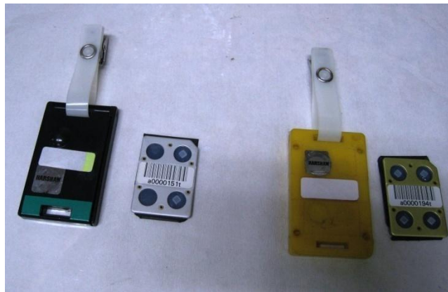
Gambar 2. TLD BG-0110 (kiri) dan TLD BGN-7776 (kanan)
