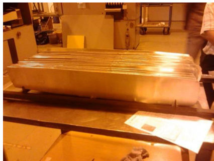
Gambar 1. 30 buah Pelat Elemen Bakar Yang Akan Dimasukan Ke Tungku Anil
