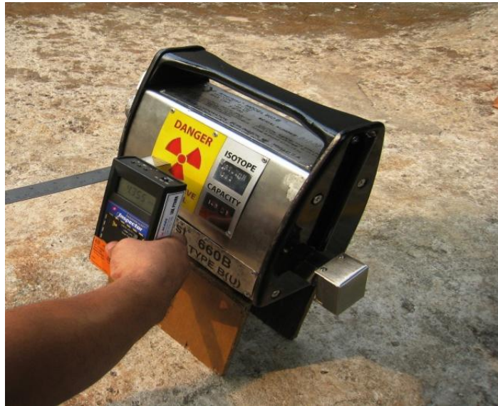
Gambar 8. Uji kebocoran radiasi pada kamera gamma tipe Amertest 660 B S/N B1822
